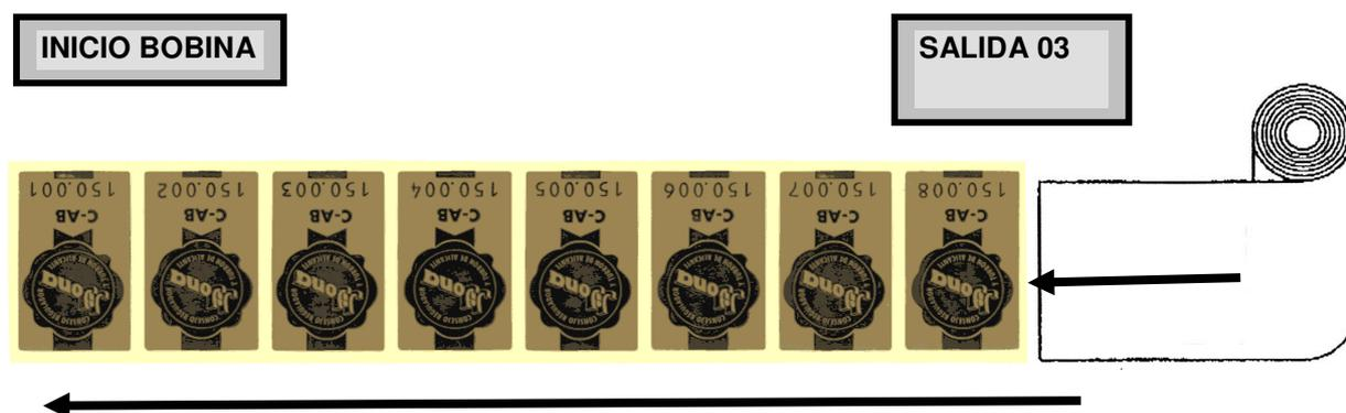
Disposición resultante de las etiquetas tras estirar una de las bobinas desde su origen. Como se observa el logotipo y series correspondientes, van orientados de derecha a izquierda del ancho de la bobina
